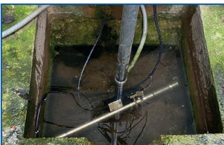
El spectro::lyser de s::can es un espectrofotómetro UV-Vis completamente sumergible que mide la absorbancia de la luz entre 190 y 750nm. Los algoritmos patentados de s::can analizan y descomponen los datos espectrales para proporcionar las medidas de muchos de los parámetros que se miden en aguas residuales, incluyendo: nitratos, nitritos, DQO, DBO, SST y H<sub>2</sub>S disueltos.
