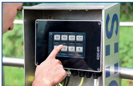
El con::cube de s::can es un terminal compacto y versátil que recoge datos y controla la estación. Provisto de un procesador de última generación y opciones muy flexibles para conectarse a SCADA o a cualquier otro sistema de base de datos, hacen que el con::cube combinado con el moni::tool sea un terminal muy potente para el control de una estación compacta.
