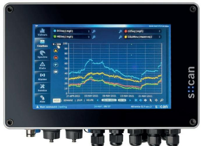
Die gemessenen Parameter werden über die moni::tool-Software auf dem con::cube angezeigt. Wenn sich Werte schnell verschlechtern oder bestimmte Grenzwerte überschreiten, wird Alarm ausgelöst. Dadurch können sofortige Maßnahmen eingeleitet werden.
