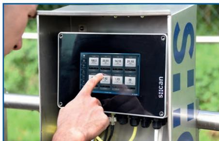
Der con::cube ist ein kompaktes und vielseitiges Bediengerät für die Datenverwaltung und Steuerung von Messstationen.
