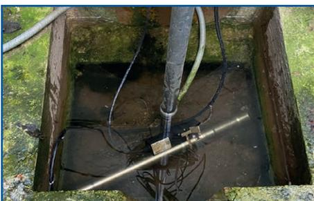
Der spectro::lyser ist ein UV-Vis Spektrometer, welches die Absorption im Bereich von 190 – 750 nm misst. Algorithmen berechnen aus den spektralen Rohdaten Wasserqualitätsparameter.
