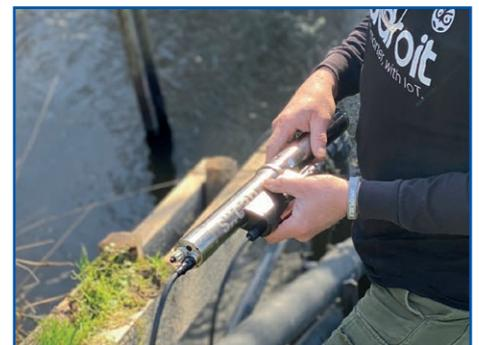
s::can的硝氮传感器nitro::lyser配有一个用于自动清洁装置ruck::sack。ruck::sack包含一个用于清洁窗口的清洁刷部件。这种形式的窗口清洁方式可以大大减少维护时间，通过降低日常维护成本，使客户更具成本效益。
