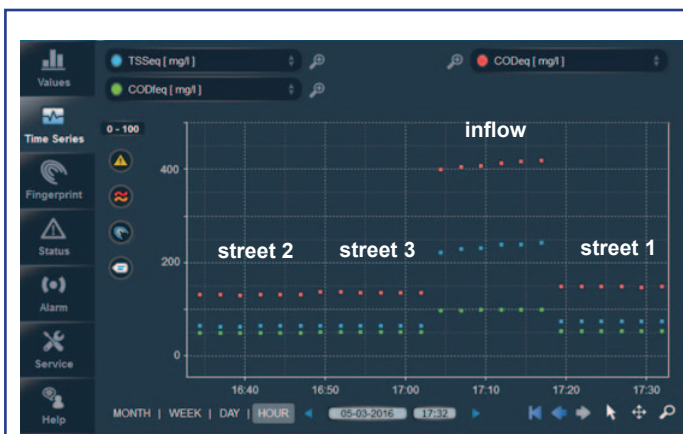
Mediciones de SST, DQO y DQOf en la entrada, en el efluente de la calle 1, calle 2 y calle 3 durante 15 minutos cada uno en el moni::tool.
