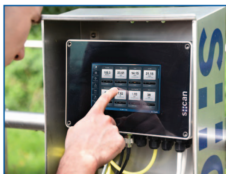
Los análisis de laboratorio confirman que hay una alta correlación entre los resultados de las medidas de DQO obtenidas a través del spectro::lyser y los resultados de laboratorio en el agua residual de entrada.
