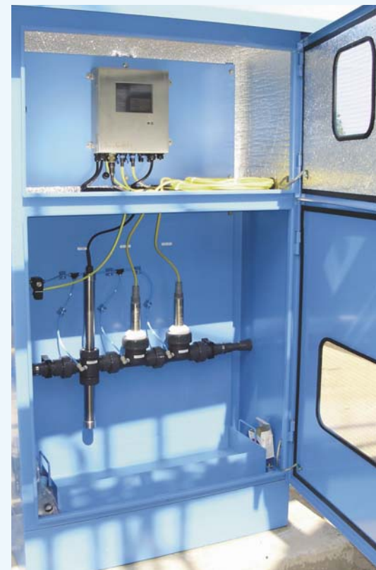
MESSTATION: mit s::can Spektrometersonde, Fabrikat spectro::lyser™, pH::lyser & condu::lyser
