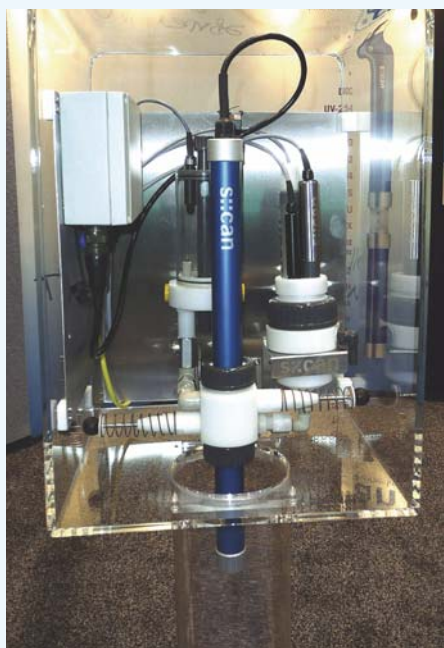
Kompakte s::can-Messstation Bild 6 zur kontinuierlichen Messung der Wasserqualität
